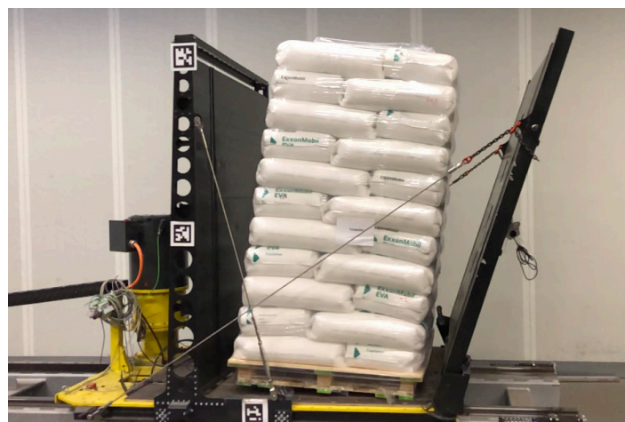
Os paletes com sacaria industrial Selene NextBag, que contém 50% de conteúdo reciclado, passaram nos testes de aceleração na ESTL, de acordo com a EUMOS 40509
