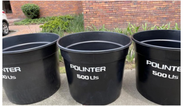
Tanque com PEBDL C6 e porcentagem usual de PCR e incorporação de PIR (aparência opaca)
