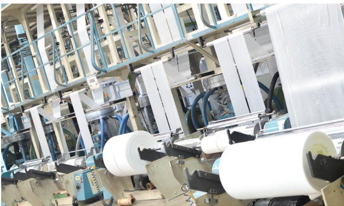
Rollos de película termoencogible con contenido PCR del 25% producidas en la planta Ternova.
