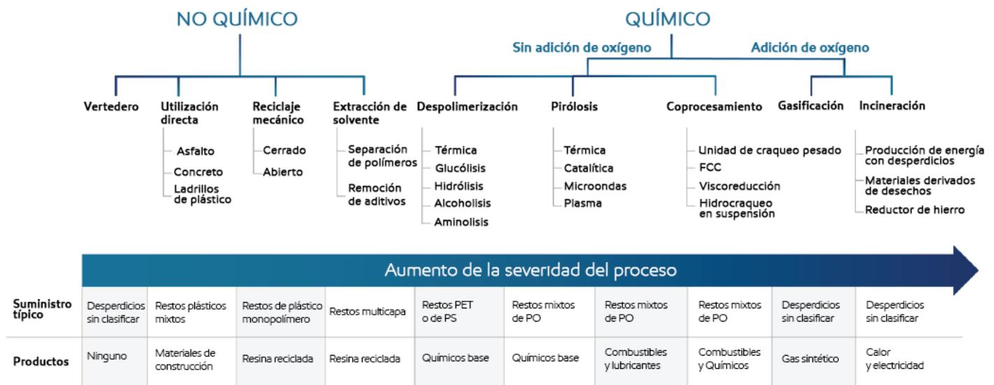
**Figura 2. Tecnologías para el final de la vida útil de los plásticos**
